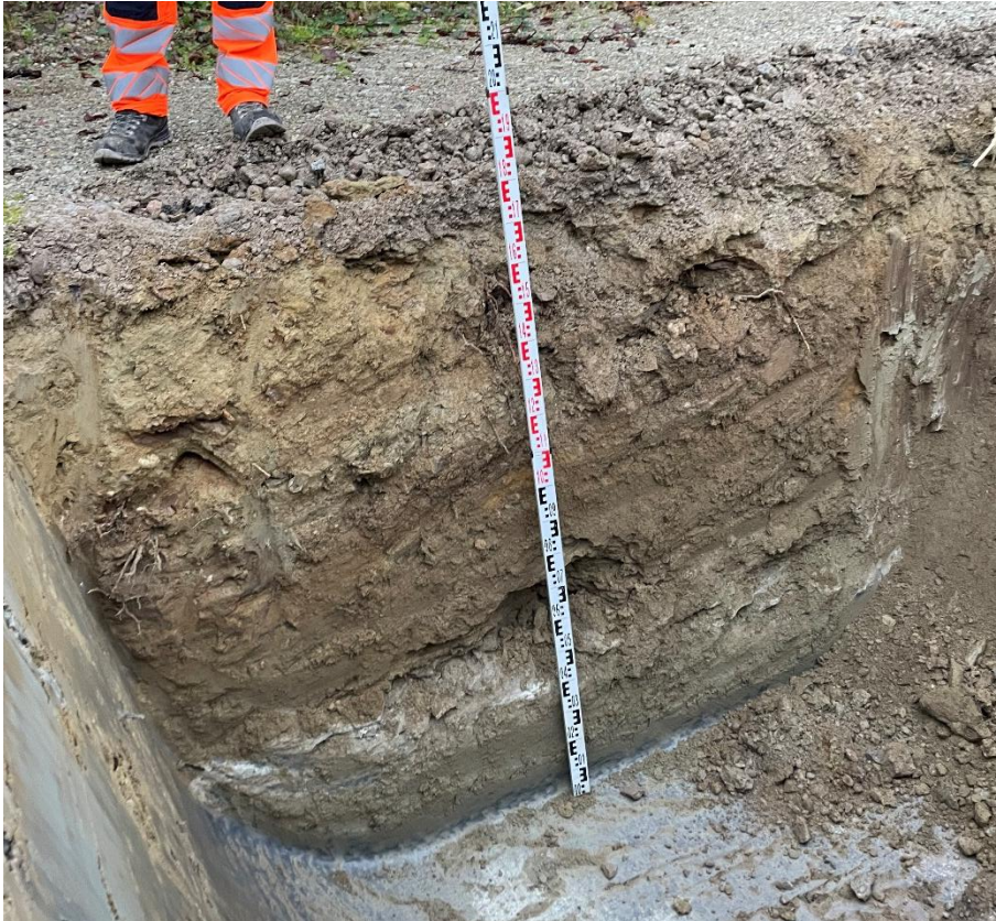
Abbildung 4: Bodenaufschluss beim künftigen QWPW-Standort, GEOTEST AG, 12.11.2024.
