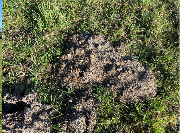
Übersicht Projektperimeter, Senke, oberflächlich Fremdmaterial (Ziegelbruch)
