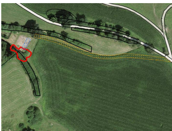
Abbildung 10: Ausschnitt Anhang F.0 pegeol AG: Aushub-perimeter (rot) , Zwischenlager (blau), Baupiste (gelb)
