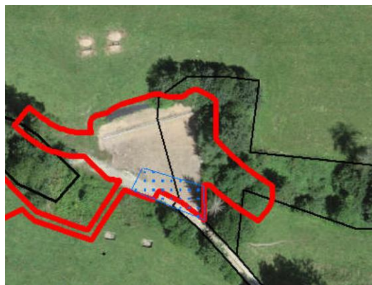
Abbildung 12: Ausschnitt Anhang F.0 pegeol AG: Aushubperimeter (rot), Zwischenlager (blau)
