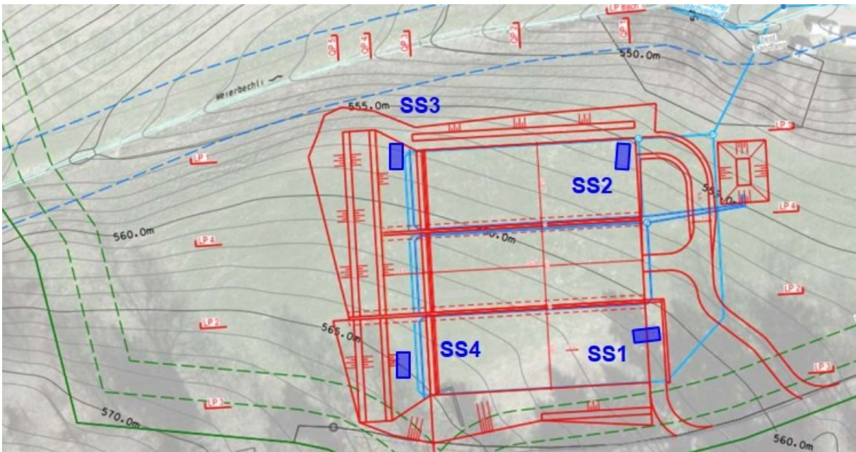
Abb. 10 Standorte der Sondagen SS1 – SS4 (Baggerschlitze) [14]
